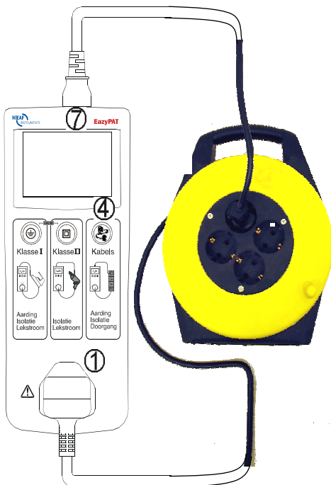
Figuur 9: Testen Verlengkabels / Haspels
