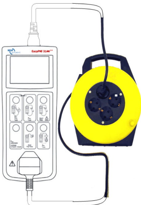
Figuur 9: Testen van verlengsnoeren en haspels
