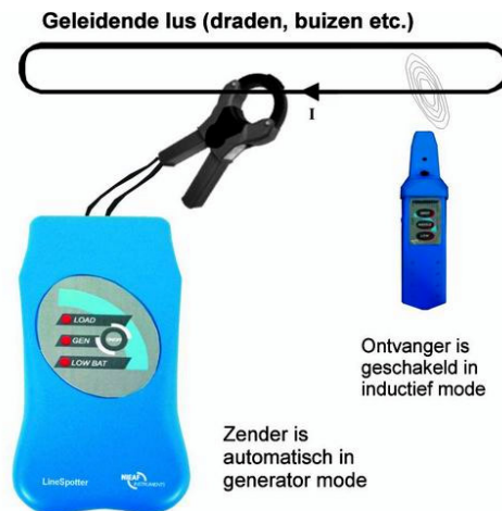
Figuur 8: injecteren van teststroom d.m.v. een stroomtang
