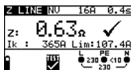
Figuur 51 Voorbeeld van meetresultaten Netimpedantie
