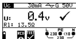
Figuur 32 Voorbeeld van meetresultaten aanraakspanning
