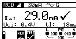
Figuur 36 Voorbeeld meetresultaat uitschakelstroom
