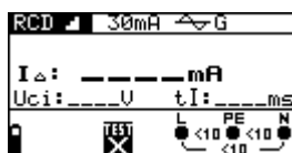
Figuur 35 Menu meten uitschakelstroom
