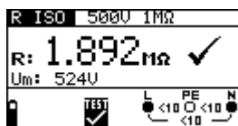
Figuur 19 Voorbeeld van meetresultaten isolatieweerstand
