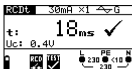
Figuur 34 Voorbeeld van meetresultaten uitschakeltijd
