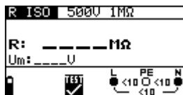
Figuur 17 Menu meten van de isolatieweerstand
