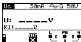
Figuur 30 Menu meten aanraakspanning
