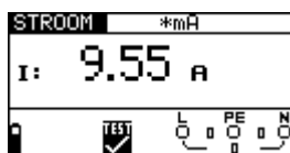
Figuur 63 Voorbeeld meetresultaat TRMS-stroom
