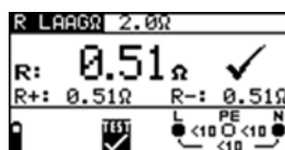
Figuur 24 Voorbeelden van meetresultaten van de weerstand R_{LAAG}
